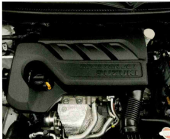
Der drehmomentstarke Einliter-Boosterjet arbeitet mit drei Zylindern und Direkteinspritzung und leistet 111 PS/170 Nm.
