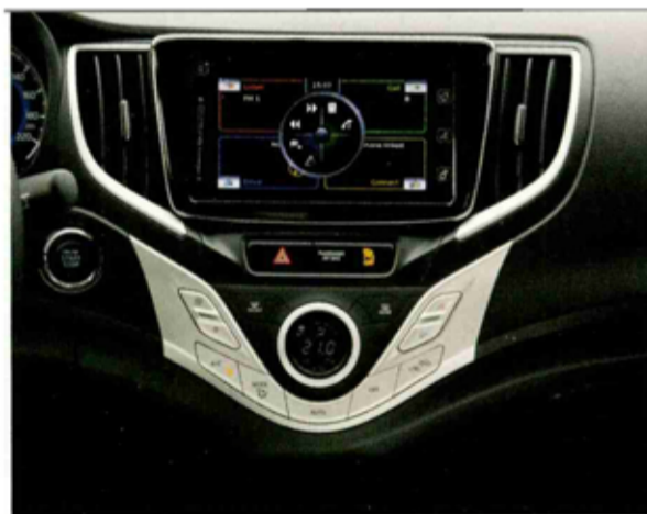
Dank Touchscreen beschränkt sich die Anzahl Knöpfe in der Mittelkonsole auf ein Minimum.
